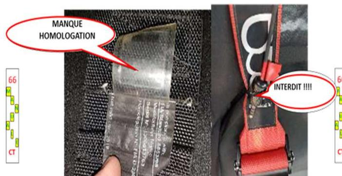
Tutte le cinghie delle cinture devono recare un'etichetta di omologazione (l'etichetta di omologazione è l'etichetta cucita su una cinghia collegata in permanenza alla fibbia di chiusura) o di identificazione (l'etichetta di identificazione è l'etichetta cucita sulla cinghia non collegata in permanenza alla fibbia di chiusura). Su tutte le etichette devono apparire almeno la data di fine validità preceduta dalla menzione "Not valid after" ed il numero di omologazione.
