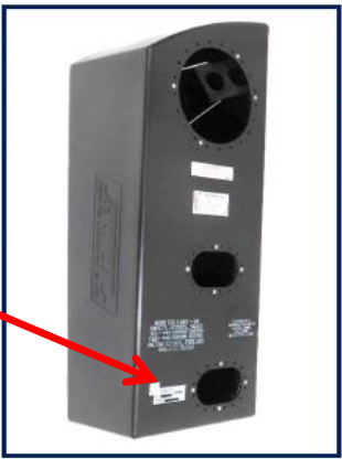
D1-1) Réservoir de carburant - déposé Fuel tank - dismounted
